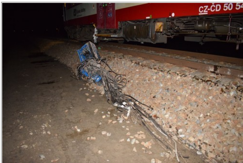
Obr. č. 3: Utržený a vlečený ovládací panel vrtné soupravy za prvním podvozkem vlevo ve směru jízdy vlaku Os 11542 Zdroj: DI
