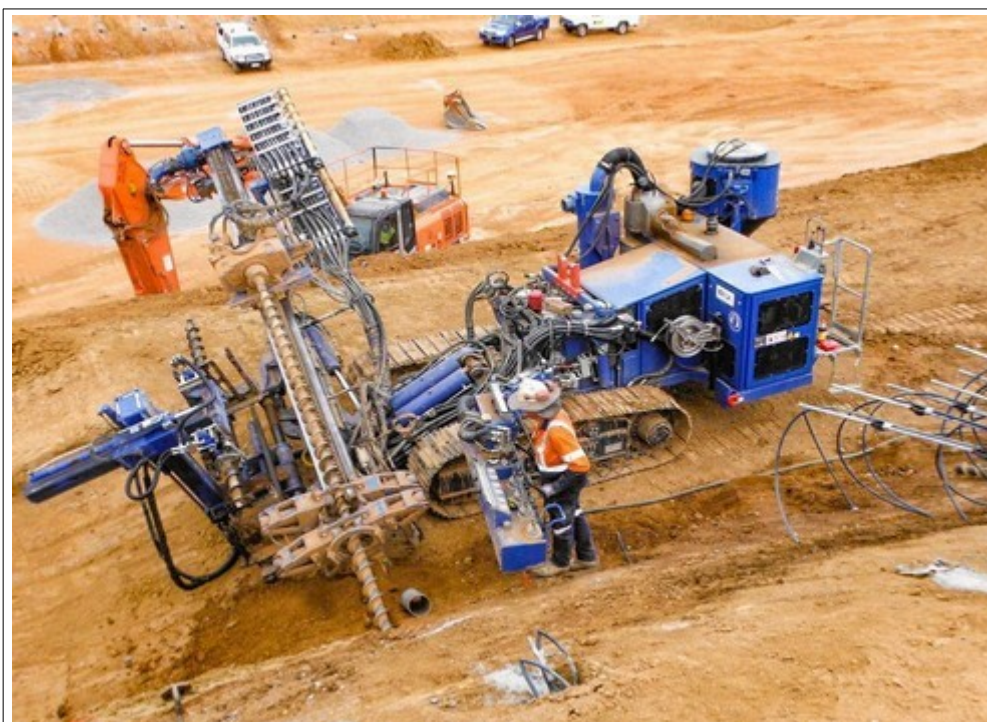
Obr. č. 2: Ukázka obdobné vrtné soupravy Hütte HBR 605-4 s ovládacím panelem v pracovní pozici Zdroj: https://huetten-bohrtechnik.com
