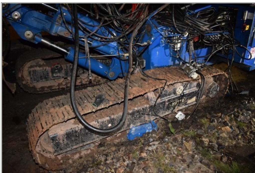
Obr. č. 4: Detail poškození levého boku vrtné soupravy HÜTTE HBR 605-3 Zdroj: DI
