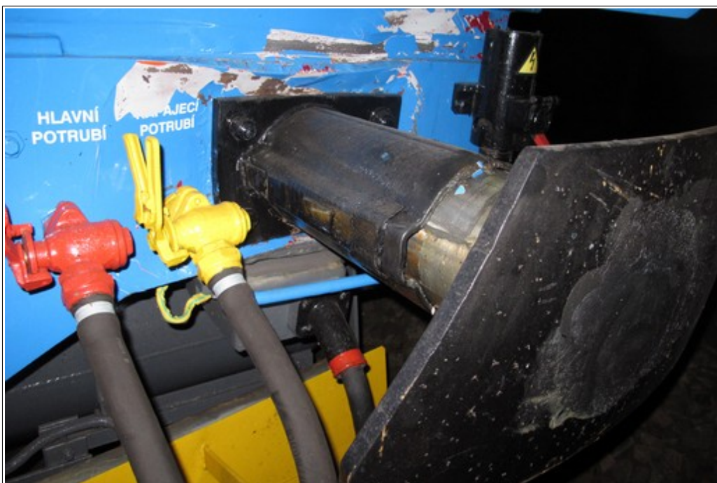
Obr. č. 3: Pohled na deformovaný čelník a nárazecí ústrojí HDV 372.006-7 po vzniku MU. Zdroj: DI
