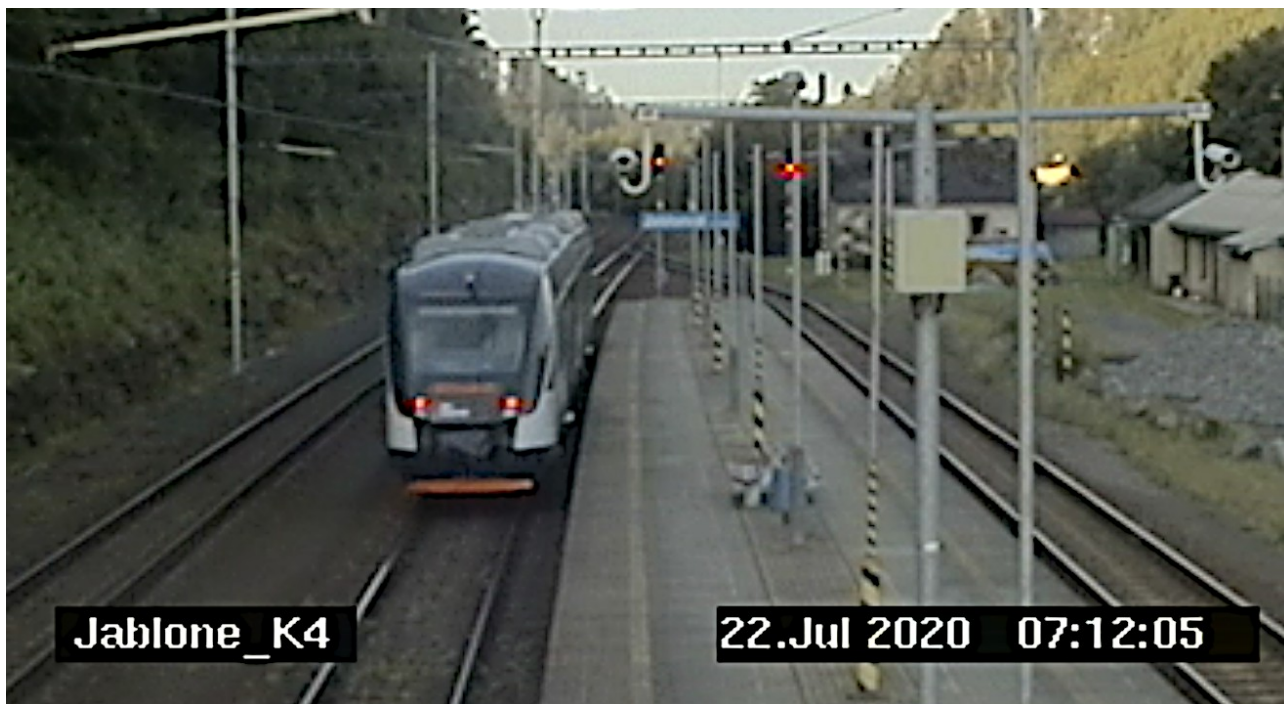
Obr. č. 4: Nástupištní kamera v žst. Jablonec ukazuje jízdu vlaku Os 7152 proti návěsti „Stůj“.
