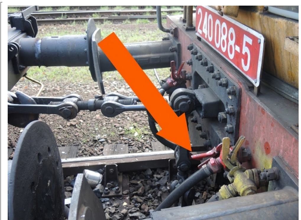
Obr. č. 7: Ukázka otevřeného spojkového kohoutu mezi HDV a 1. TDV vlaku Pn 52184 po příjezdu DI na místo MU
