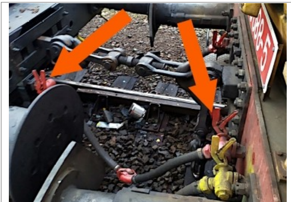
Obr. č. 6: Uzavřené spojkové kohouty mezi HDV a 1. TDV vlaku Pn 52184, foto pořízené bezprostředně po zastavení vlaku po MU
