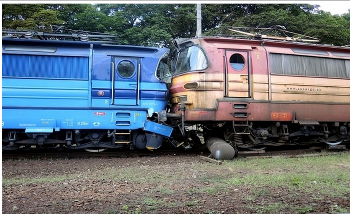
Obr. č. 5: Sražená a zaklíněná HDV po zastavení. Vlevo odstavené HDV, vpravo vlakové HDV
