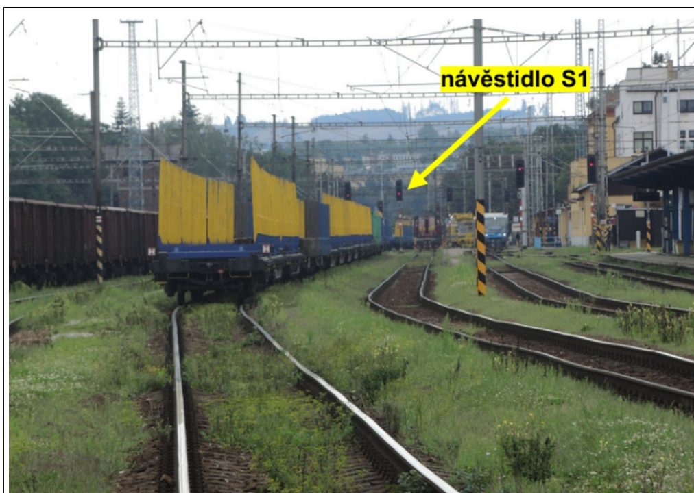
Obr. č. 4: Viditelnost návěstidla S1 a návěstěné návěsti „Stůj“ od návěstidla L3, ze vzdálenosti 496 m
