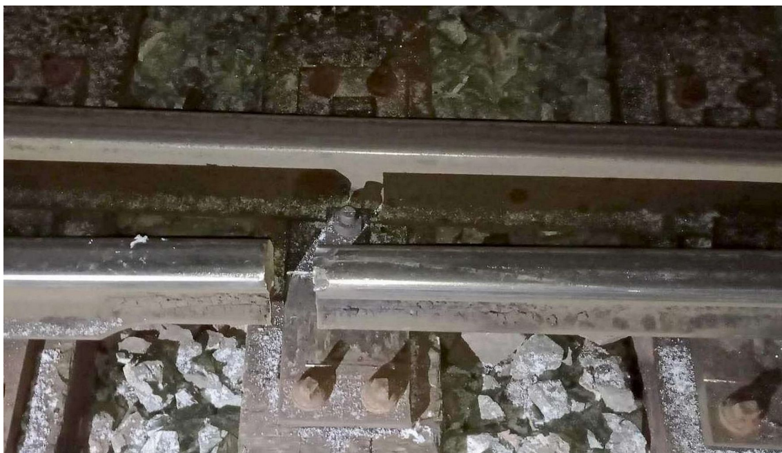
Obr. č. 2: Odlomený jazyk byl posunut o cca 8 cm ve směru jízdy vlaku (doprava). Zdroj: SŽ
