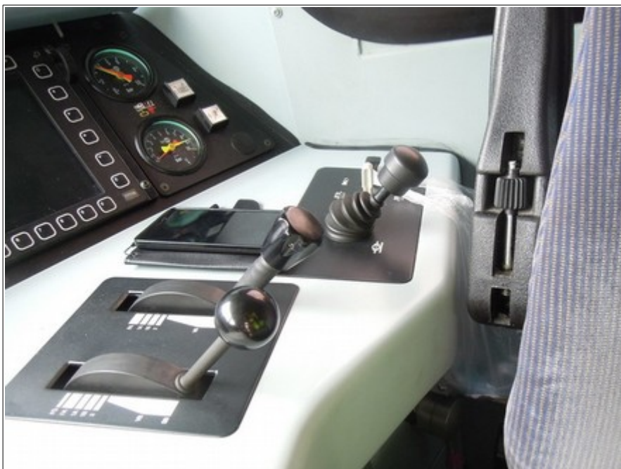
Obr. č. 3: Ovládací páky jízdního a brzdového kontroléru na stanovišti strojvedoucího 2 HDV 189.844-4 v poloze po zastavení vlaku Nex 41363 po MU.
