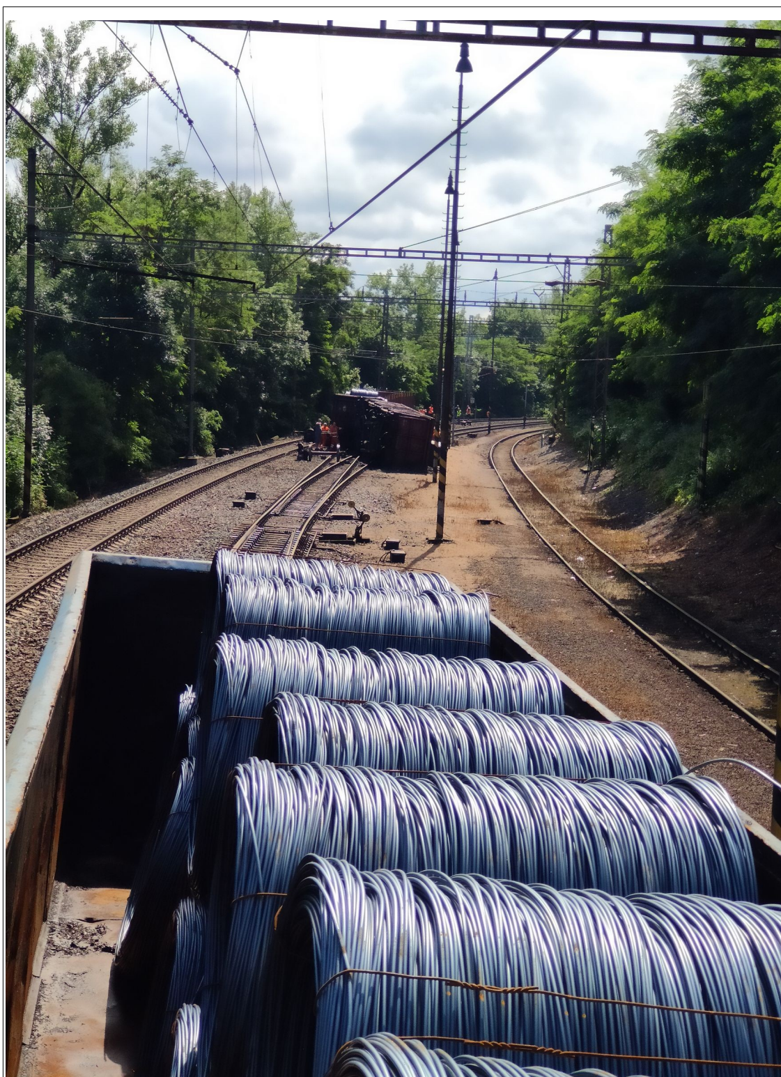
Obr. č. 9: Bližší pohled na nesprávně ložený náklad svitků drátů v posledním nevykolejeném voze, za kterým došlo k roztržení vlaku Zdroj: DI
