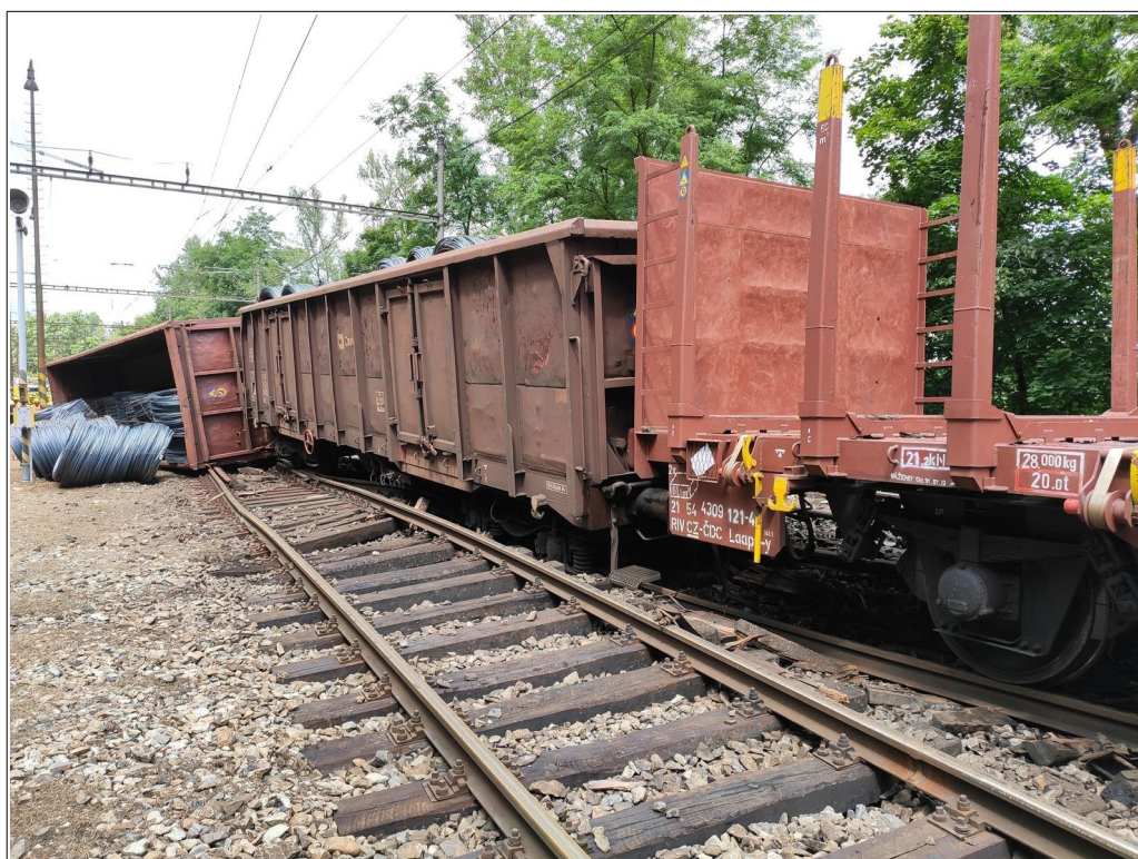
Obr. č. 6: Pohled na vykolejená DV a vysypaný náklad drátů z levé strany
