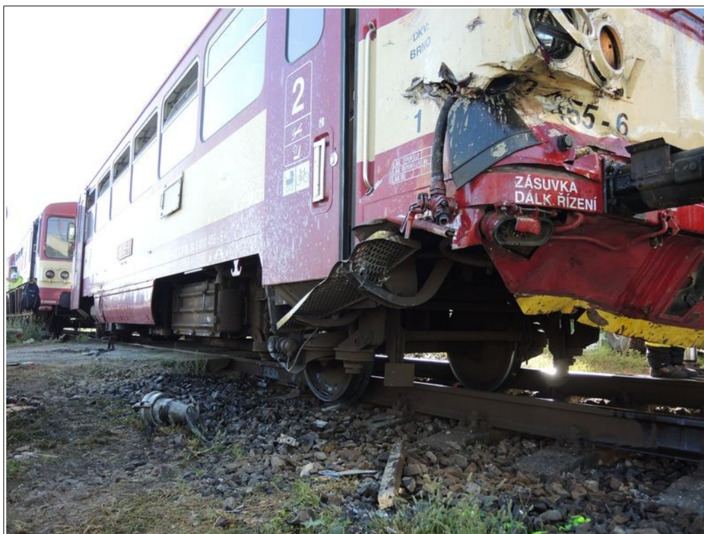
Obr. č. 5: Vykolejená přední náprava HDV 810.455-6.
