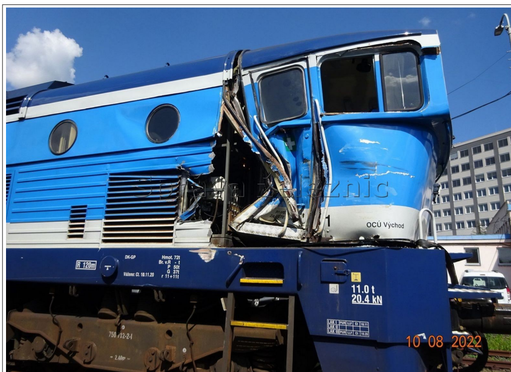
Obr. č. 8: Detailní pohled na poškození skříně HDV vlaku Os 20119.
