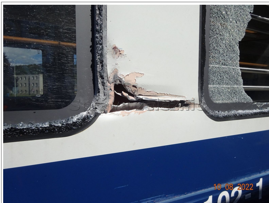
Obr. č. 6: Detailní pohled na poškození skříně VDV vlaku Os 20119.
