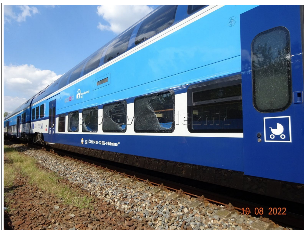
Obr. č. 7: Pohled na poškození skříně KDV vlaku Os 20119.
