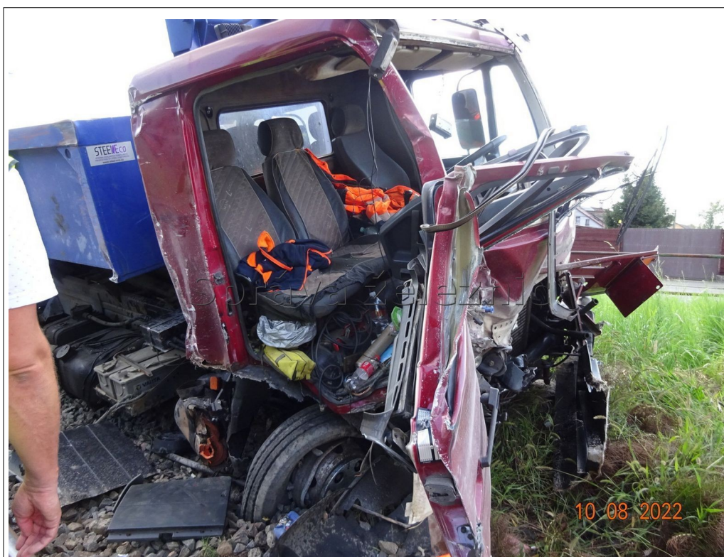
Obr. č. 9: Pohled na poškozenou kabinu NA tovární značky MAN.
