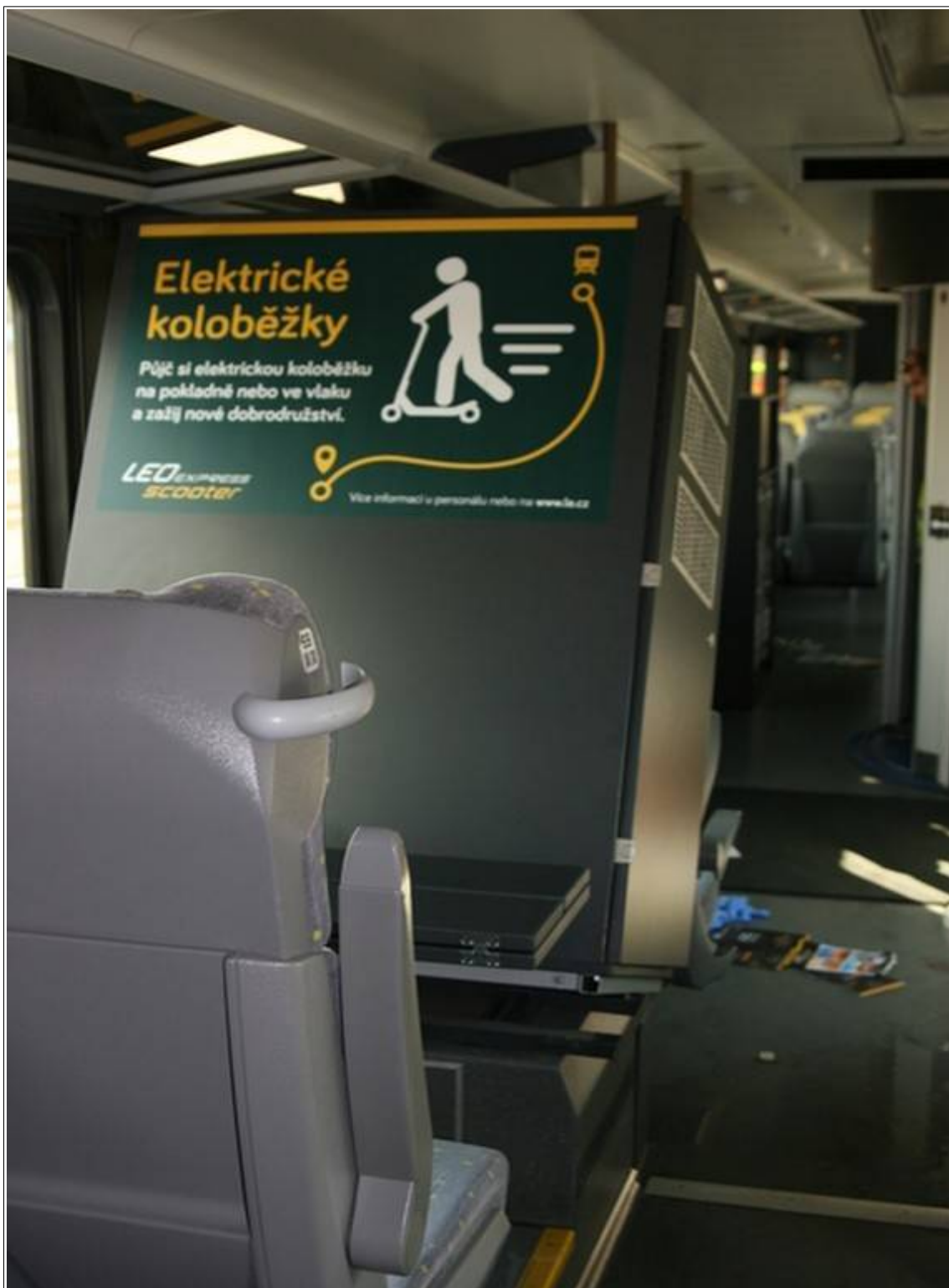
Obr. č. 14: Pohled ve směru jízdy vlaku na uvolněný a vyvrácený levý interiérový modul v sekci „C“.
