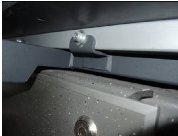
Obr. č. 5: Upevnění rámu výměnného interierového modulu horizontálně vedeným šroubem M8 procházejícím vertikální drážkou v objímce rámu sedadla.
