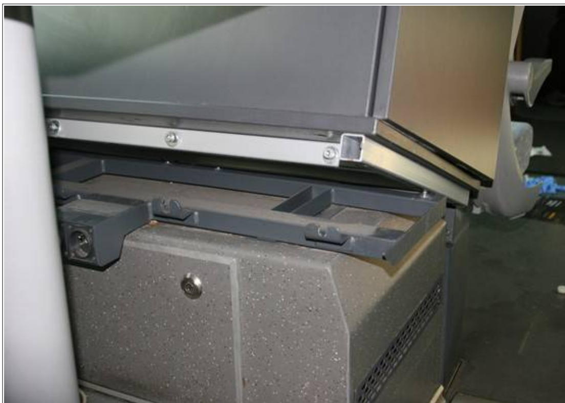
Obr. č. 3: Detail uvolnění (vysunutí) rámu výměnného interiérového modulu z dodatečně vytvořených drážek objímek rámu sedadla.
