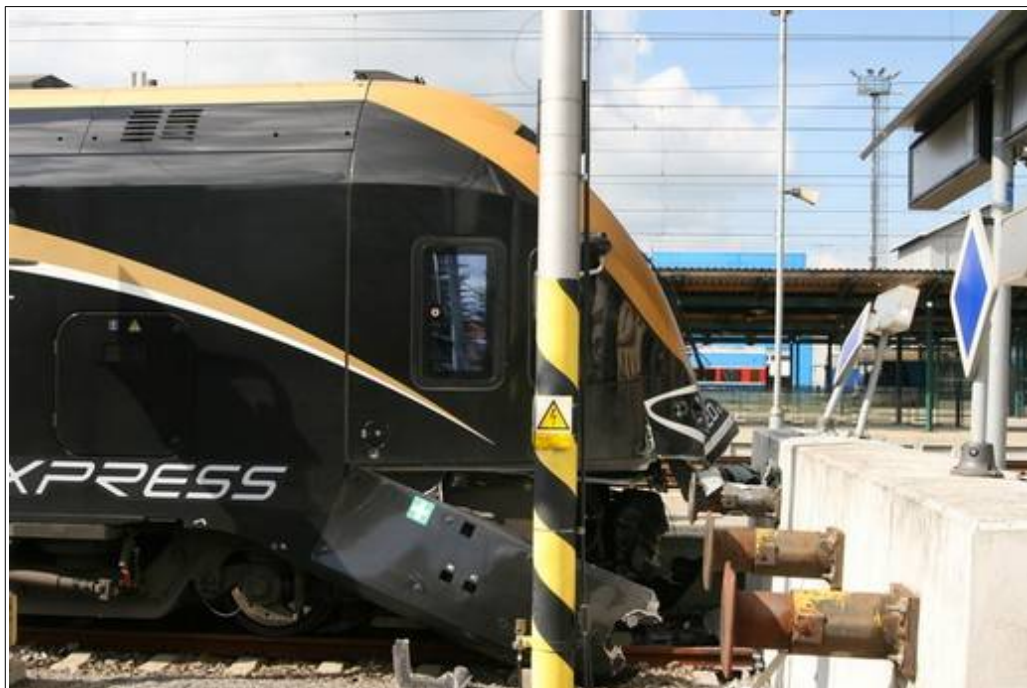
Obr. č. 8: Pohled na místo srážky vlaku Ex 1342 s betonovým zaráždlem na konci SK č. 5 žst. Přerov.
