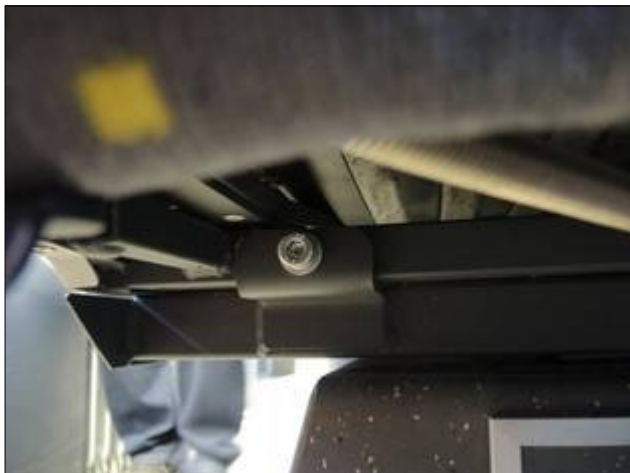
Obr. č. 4 Upevnění sedadla horizontálně vedeným šroubem M8 procházejícím otvorem v objímce rámu sedadla.
