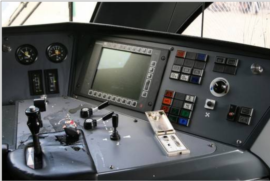
Obr. č. 12: Pohled na pravou stranu ovládacího pultu stanoviště strojvedoucího sekce „B“. V levém dolním rohu viditelná jízdní páka s integrovaným tlačítkem bdělosti mobilní části VZ.
