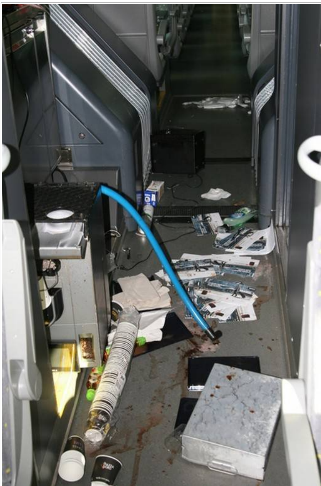
Obr. č. 15: Pohled na podlahu vnitrovozového přechodu mezi sekcemi „D“ a „A“ u prostoru cateringu se spadlým kávovarem, hliníkovou zásuvkou a chladničkou na mléko a ostatním nádobím cateringu.
