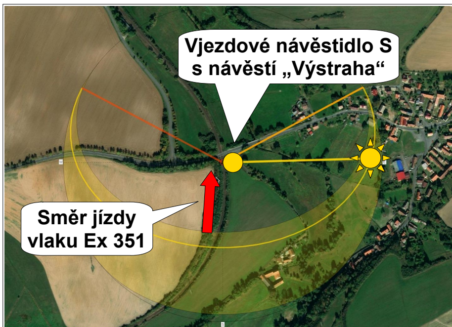
Obr. č. 8: Poloha slunce a směr slunečního svitu vůči jízdě vlaku Ex 351
