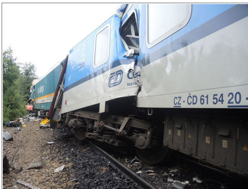
Obr. č. 4: Vykolejené nápravy předního podvozku DV Zdroj: DI
