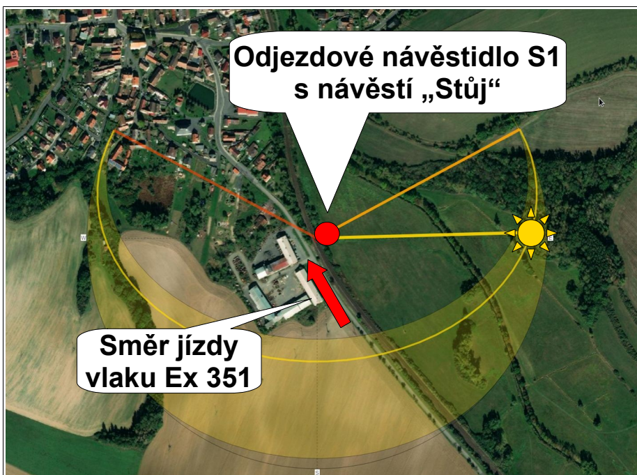
Obr. č. 9: Poloha slunce a směr slunečního svitu vůči jízdě vlaku Ex 351
