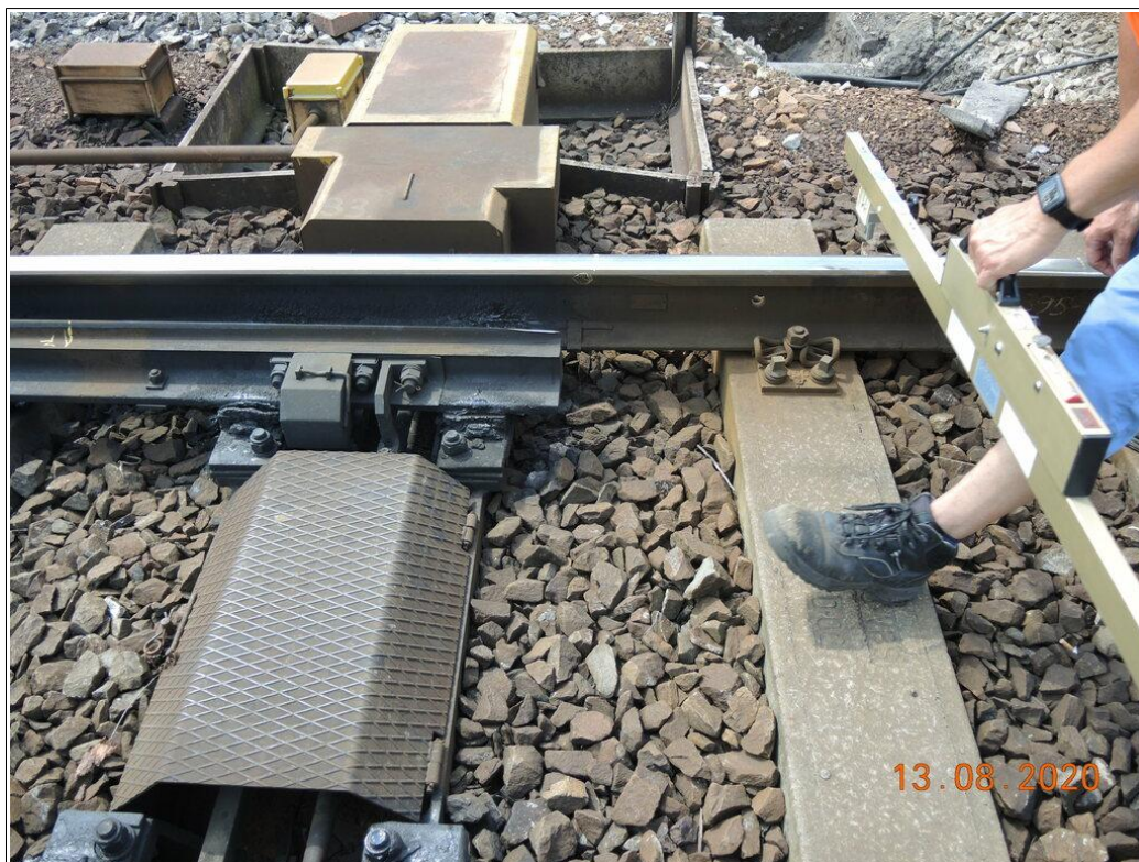
Obr. č. 8: Snímek pořízený dne 13. 8. 2020 ve 13:21:40 h ve výhybce č.33 žst. Tišnov při měření železničního svršku po MU.
