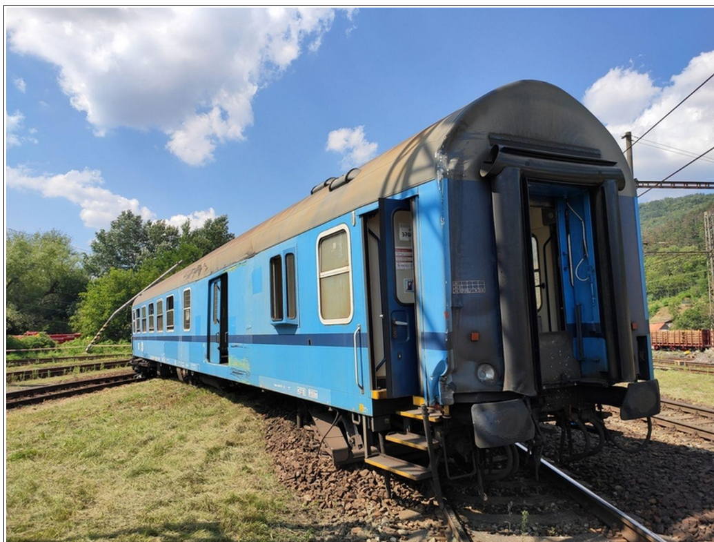
Obr. č. 4: Vykolejené TDV 51 54 82-40 401-6, řazené jako 5. TDV za HDV vlaku R 975, v konečném postavení po MU v prostoru SK č. 1 a č. 3.
