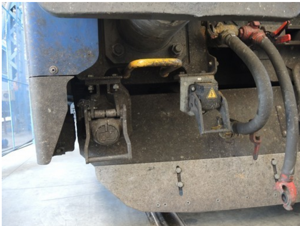
Obr. č. 4: Pozice zásuvky vlakového topení na čele HDV řady 380 (levá zásuvka na obrázku) pod pravým nárazníkem (ve směru jízdy)
