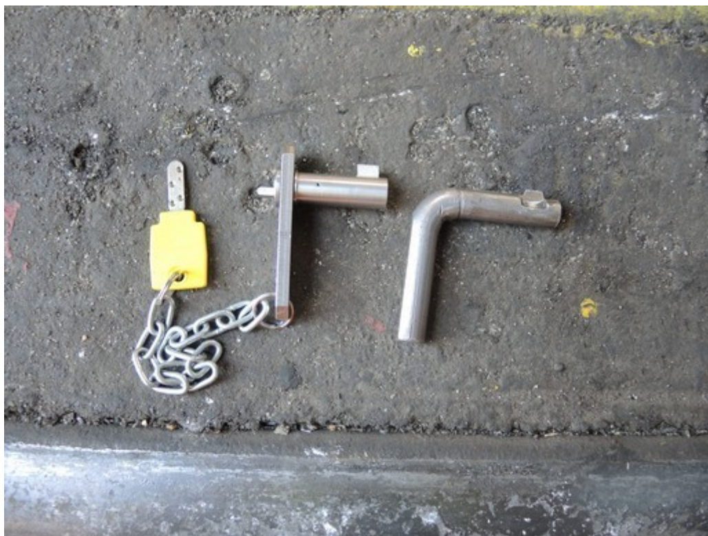
Obr. č. 3: Vlevo rakouský a vpravo český závěrný klíč vlakového topení
