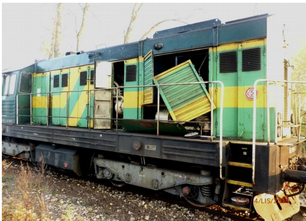
Obr. č. 6: Poškozené DV 742.156-3
