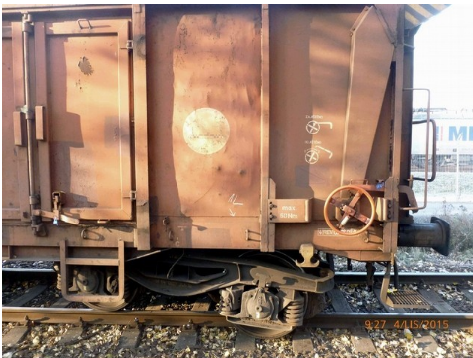
Obr. č. 4: Vykolejené 14. (předposlední) DV 1. posunového dílu
