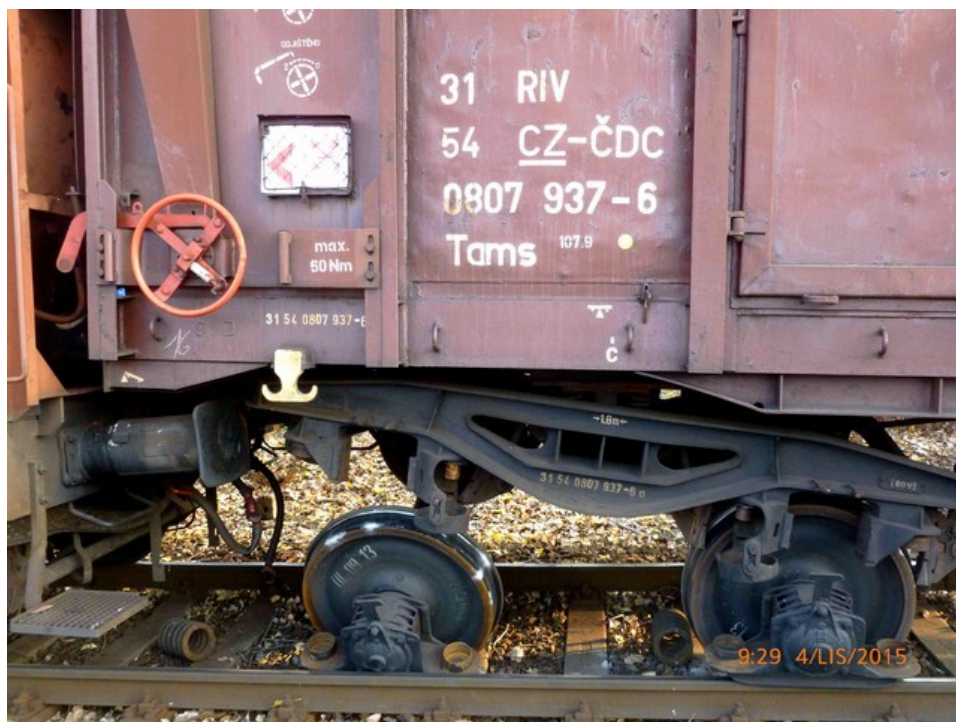
Obr. č. 5: Vykolejené 15. (poslední) DV 1. posunového dílu
