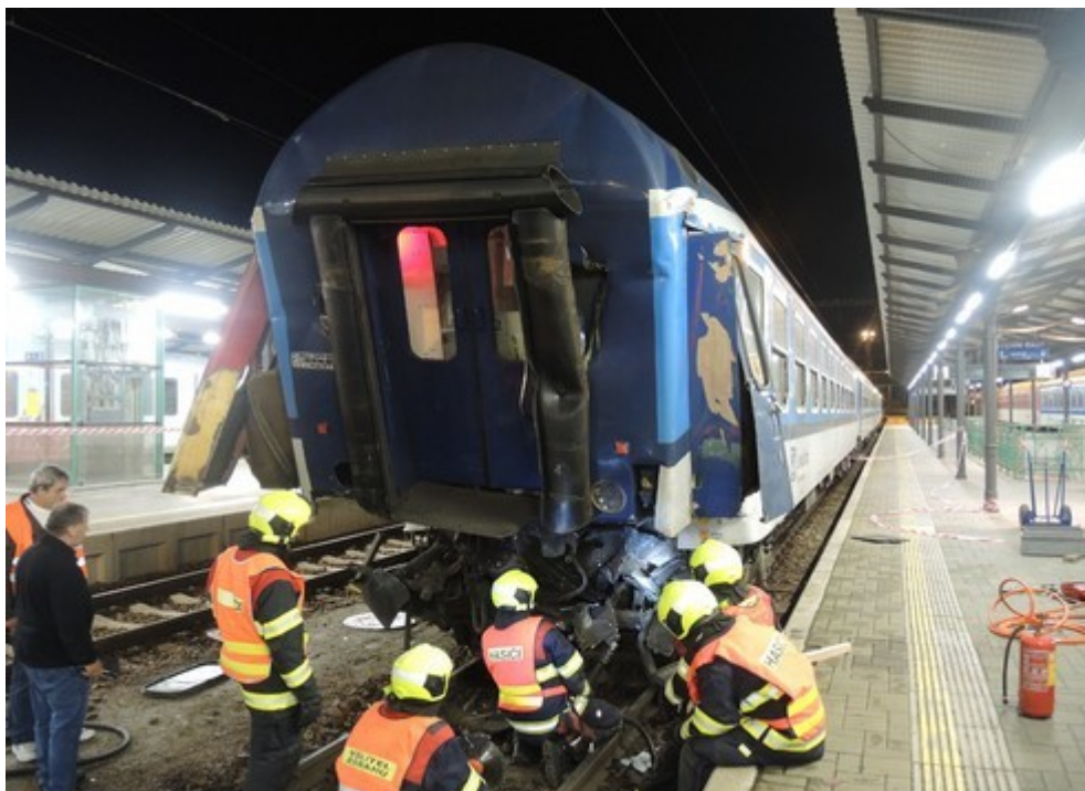
Obr. č. 3: Pohled na čelo TDV vystavené srážce po odtažení HDV
