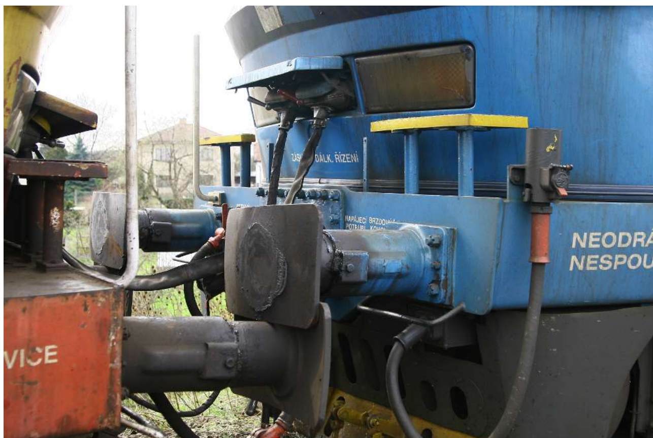
Foto 5: Zaklesnutí dvojice HDV po samovolném nakolejení prvního z nich
