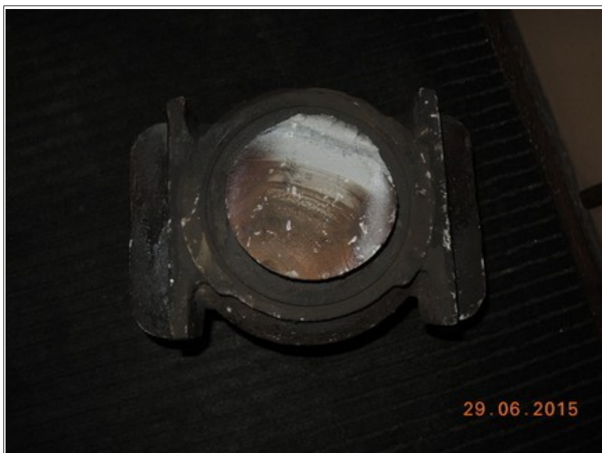
Obr. č. 5: Pohled na ulomený čep s ložiskovou komorou.
