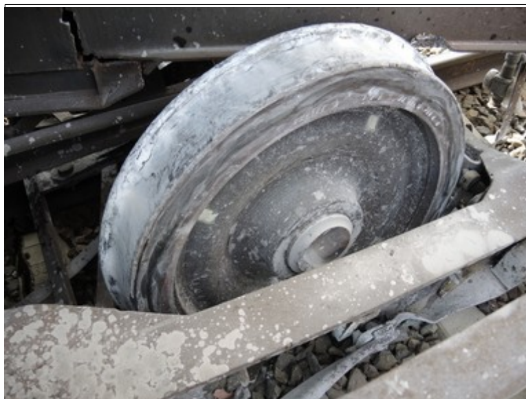
Obr. č. 2: Pohled na nápravu podvozku (b) s ulomeným čepem.
