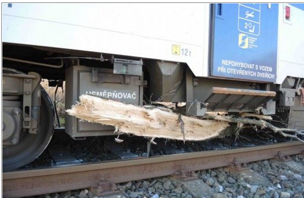
Obr. č. 5: Pohled na zaklíněnou větev spadlého stromu pod skříní vykolejeného ŘDV
