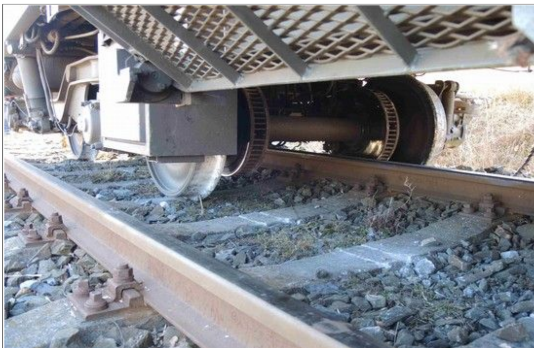
Obr. č. 4: Pohled na vykolejený přední podvozek ŘDV vlaku Sp 1661
