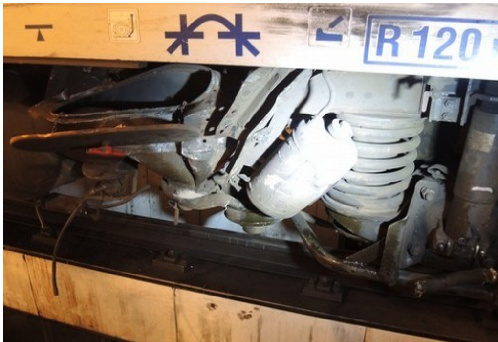
Obr. č. 8: Viditelné poškození na HDV
