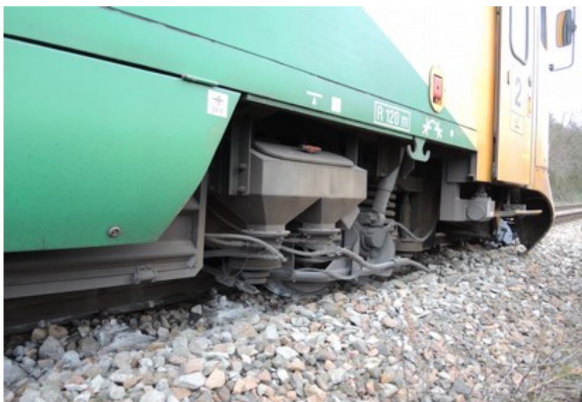
Obr. č. 6: Vykolejený přední podvozek
