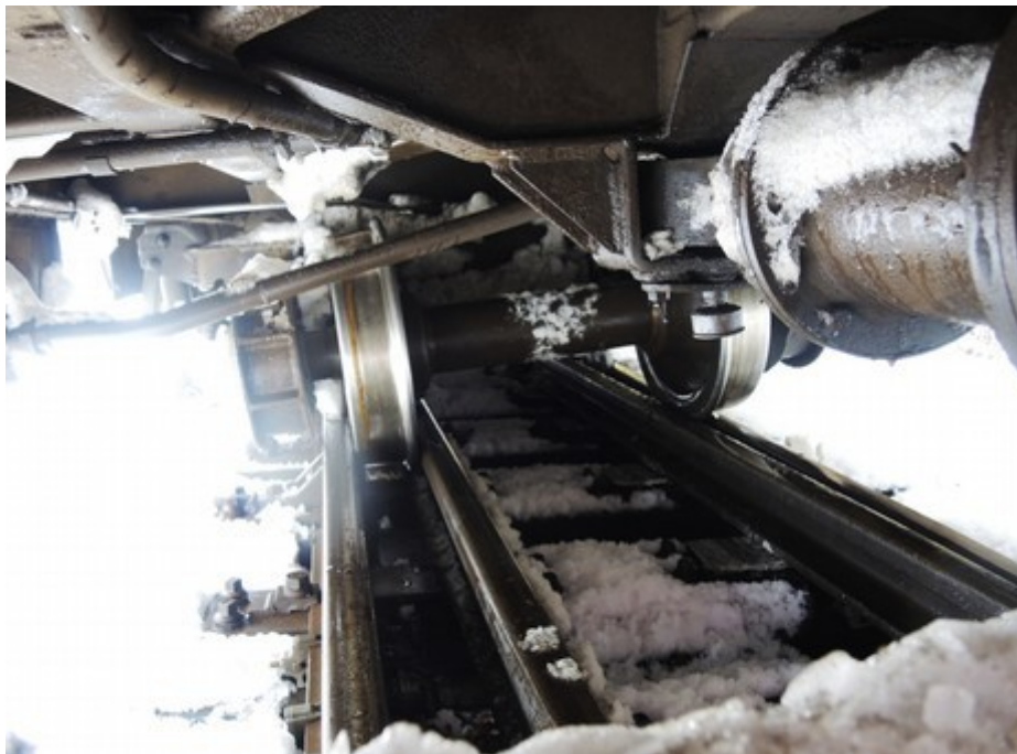
Obr. č. 1: Pohled na vykolejený podvozek TDV
