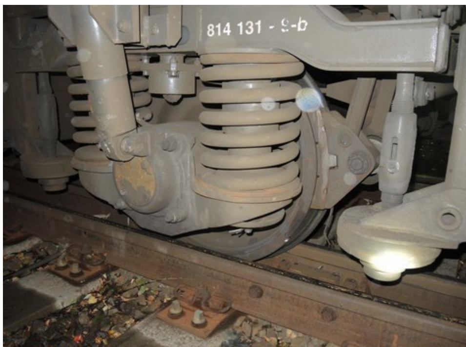
Obr. č. 1: Vykolejené kolo podvozku „b“ HDV po vzniku MU
