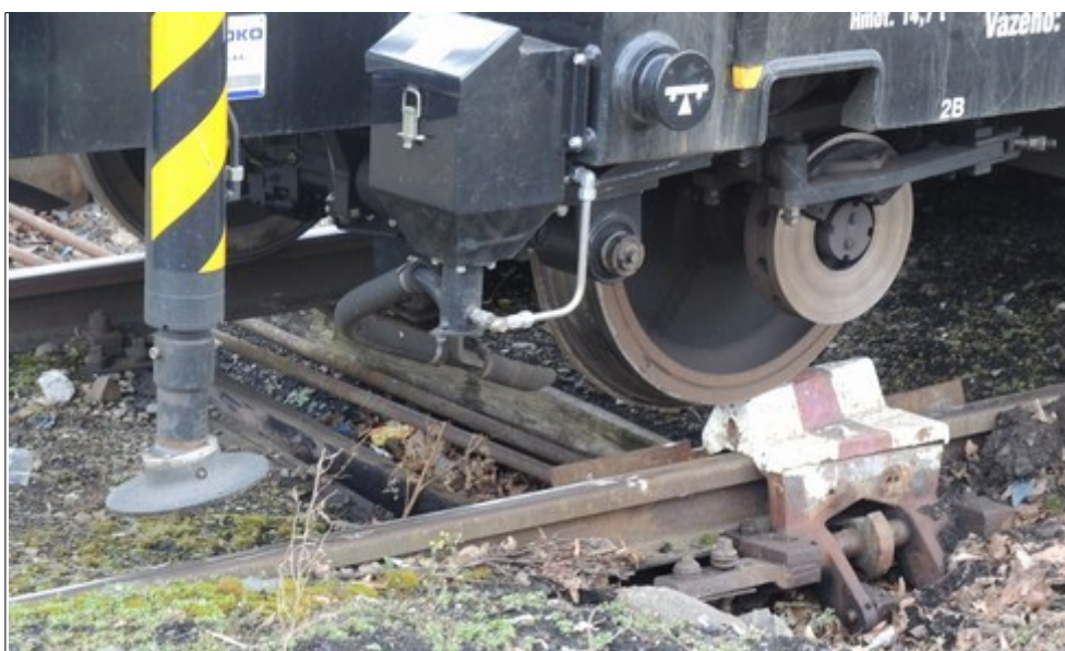
Obr. č. 3: Detail zadní nápravy vykolejeného MUV 75
