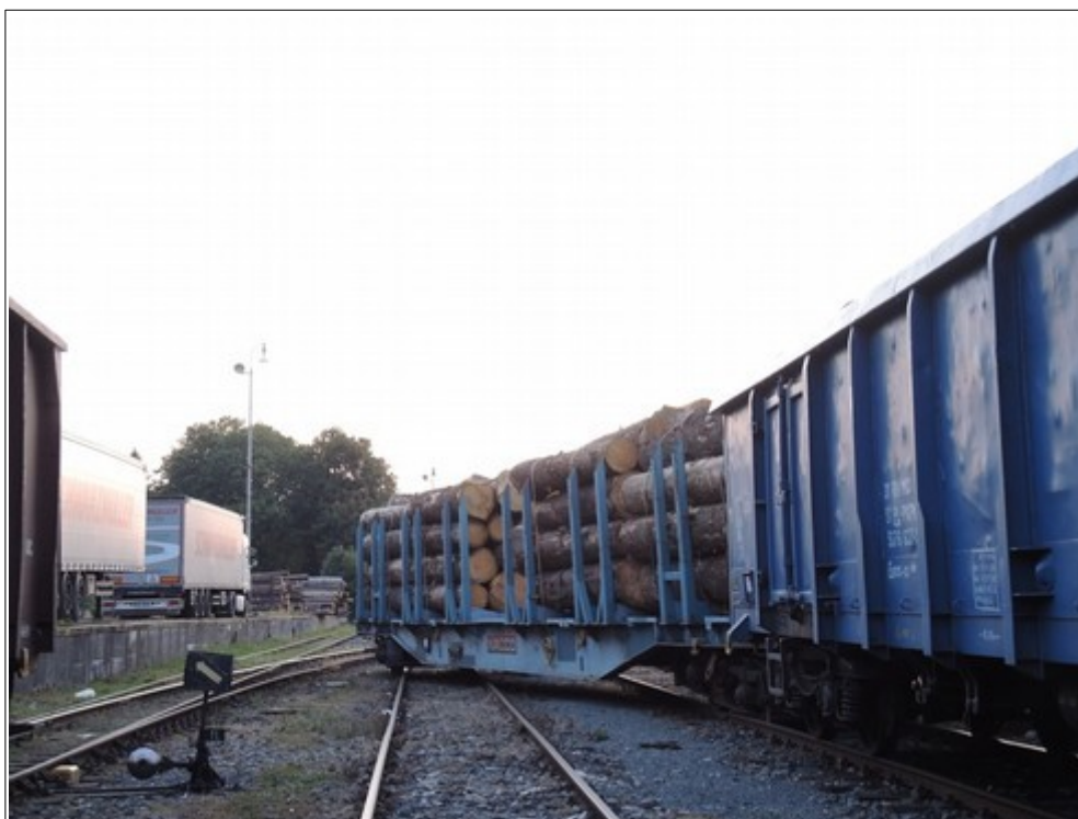
Obr. č. 1: Pohled ze směru od začátku vlaku na vykolejené TDV D-NACCO 33 80 4742 044-7 v konečném postavení po MU v dopravně D3 Rýmařov v prostoru SK č. 3 a č. 5.
