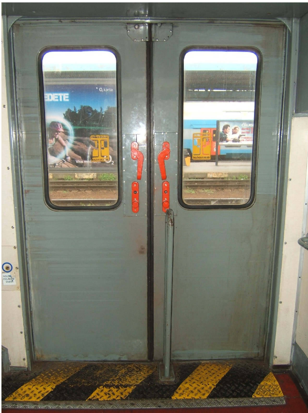
Foto 3: Dveře vozu řady Bmto a jejich ovládací prvky
