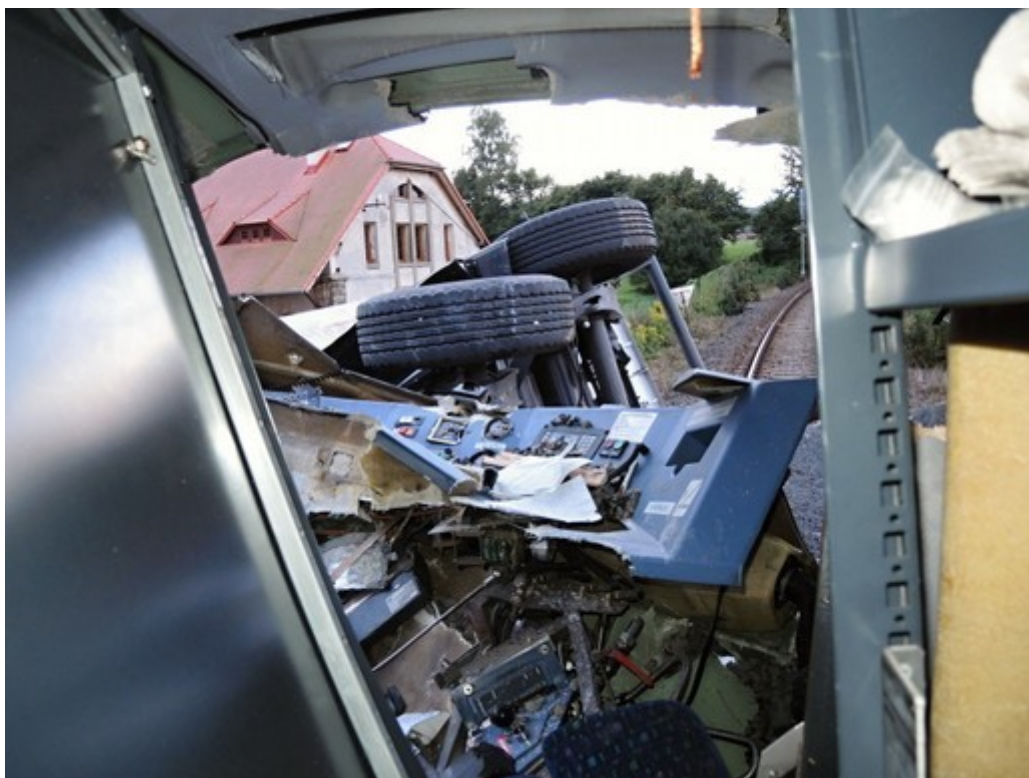
Obr. č. 9: Pohled na zdemolované stanoviště strojvedoucího
