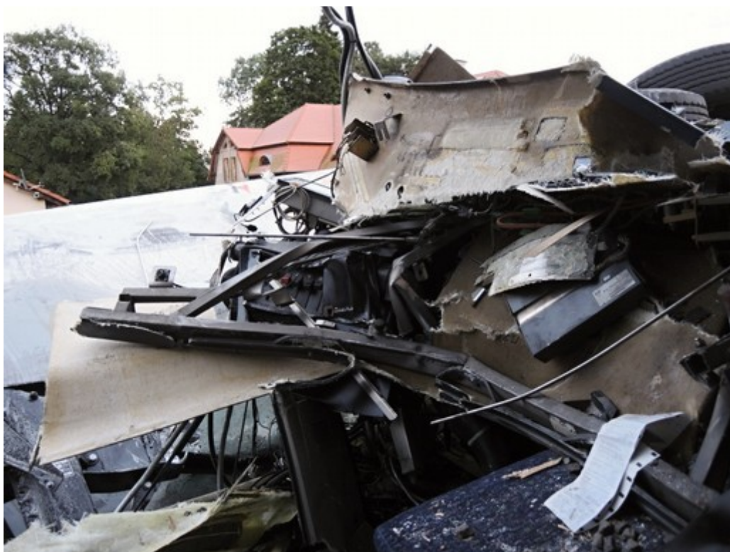
Obr. č. 10: Pohled na zdemolované stanoviště strojvedoucího
