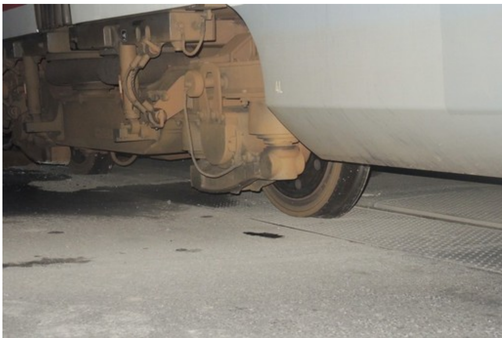
Obr. č. 8: Vykolejený podvozek B motorové jednotky VT 642 Desiro
