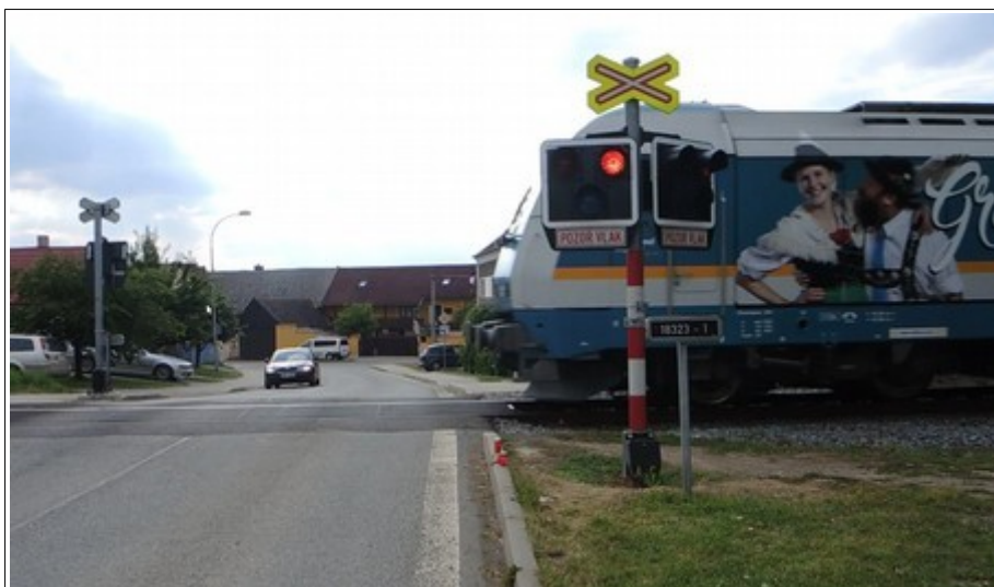
Obr. č. 6: Ověření doby výstrahy (přibližovací doby) při jízdě vlaku Ex 352
