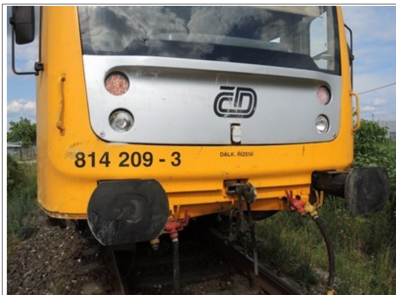
Obr. č. 7: Pohled na čelo HDV po odstranění zaklíněného DA
