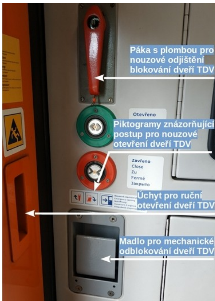
Obr. č. 3: Popis ovládacích prvků pro nouzové otevření dveří TDV
