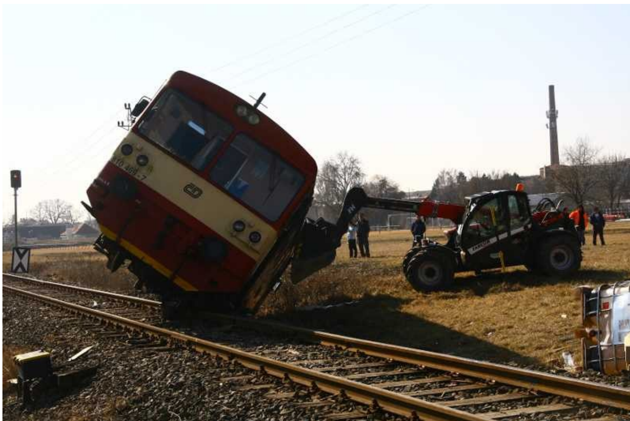
Obr. č. 4: Vykolejené HDV zajištěné manipulátorem Faresin, ve směru od žst. Kobyly na Moravě
