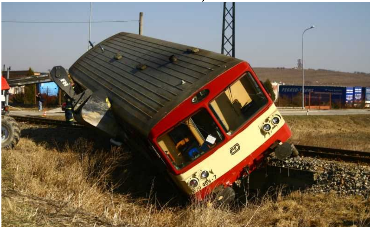
Obr. č. 5: Vykolejené HDV zajištěné manipulátorem Faresin, ve směru od žst. Velké Pavlovice
