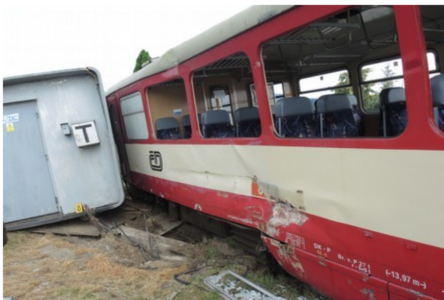
Obr. č. 4: Vykolejené HDV a poškozený technologický domek ŽP
