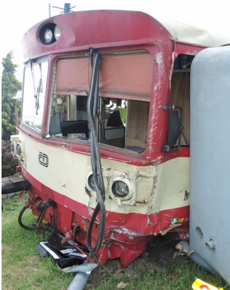
Obr. č. 7: Čelo HDV po střetnutí, pod ním zničený výstražník
