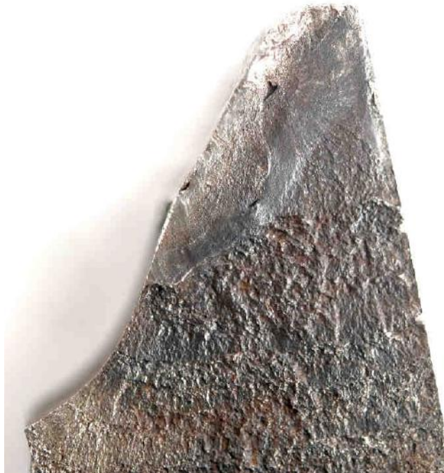
Obr. č. 4: Oblast iniciace porušení celistvosti Zdroj: VTC
