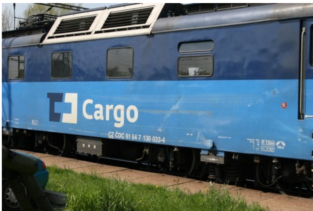
Obr. č. 8: Poškozené HDV vlaku Pn 66301
