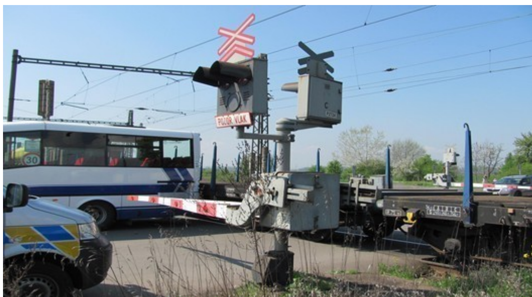
Obr. č. 7: Zasahování zadní části autobusu do nebezpečného pásma železničního přejezdu P2724
