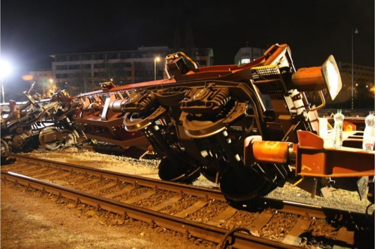
Foto 1: Pohled na vykolejené DV
