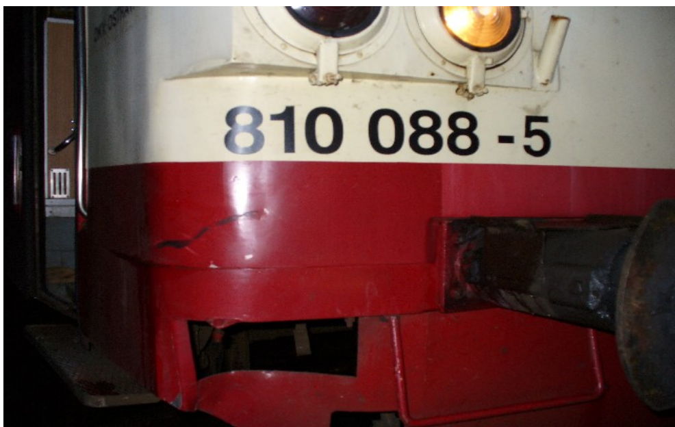
Foto 1: Pohled na částečně deformovanou pravou stranu vlakového HDV 810.088-5.
