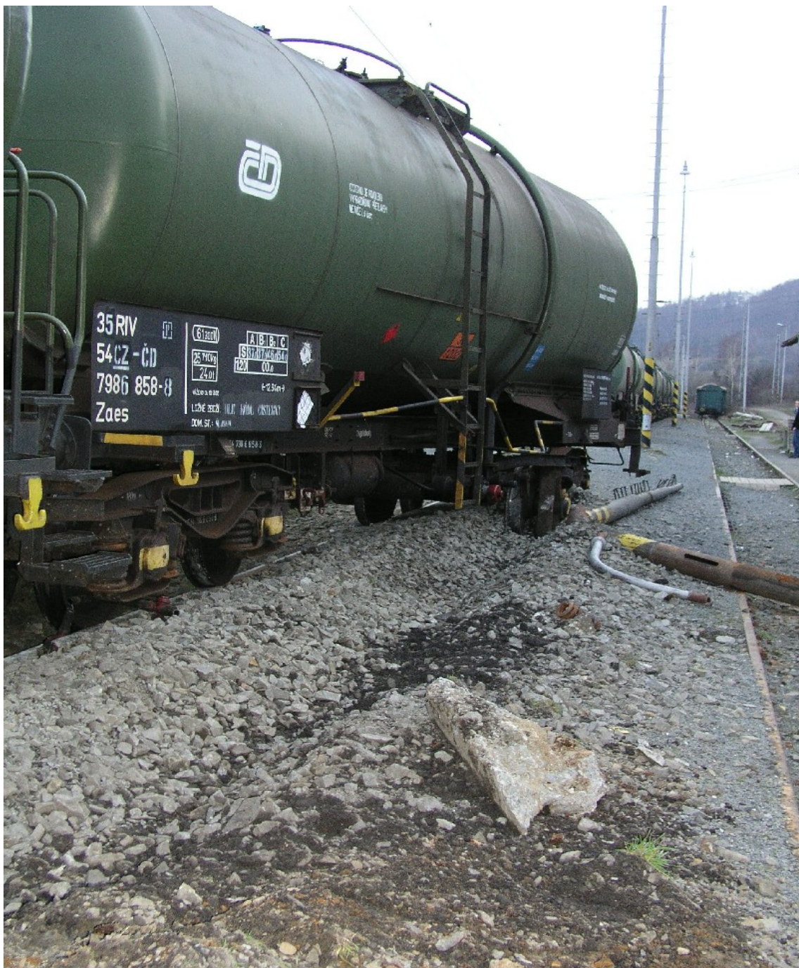
Foto 1: pohled na tažené drážní vozidlo Zaes 35 54 7986 858-8 řazené jako deváté za HDV nákladního vlaku Pn 67113 ve vykolejeném a poškozeném stavu po zastavení ve staniční koleji č. 3 železniční stanice Hranice na Moravě město
