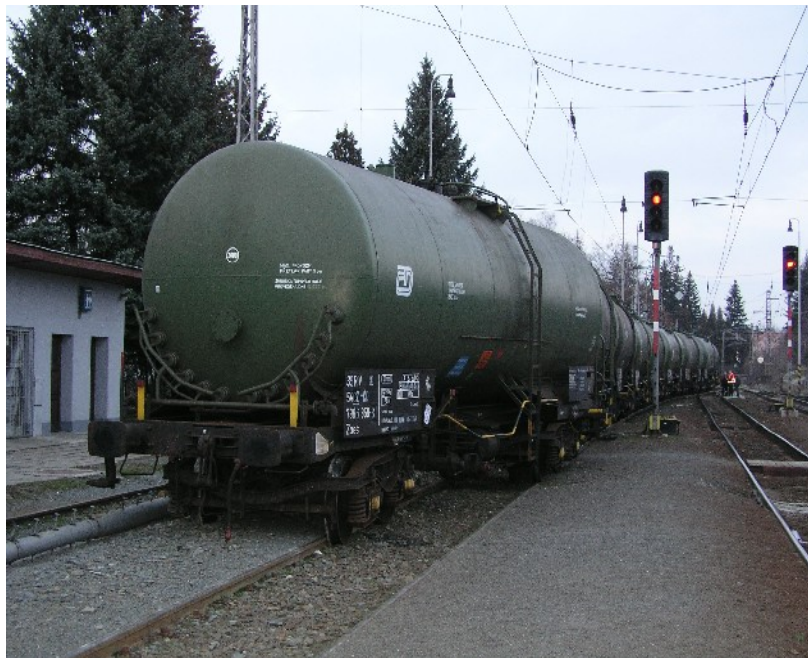
Pohled na tažené drážní vozidlo Zaes 35 54 7986 858-8 řazené jako deváté za hnacím drážním vozidlem nákladního vlaku Pn 67113 ve vykolejeném a poškozeném stavu po zastavení ve staniční koleji č. 3 železniční stanice Hranice na Moravě město
