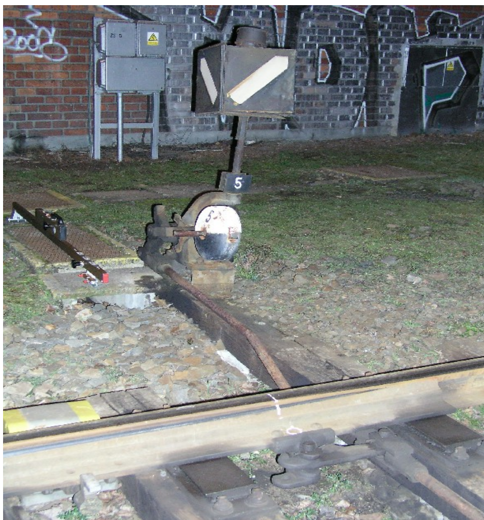
Foto 2: pohled na komisionálně stanovený bod 0 - první stopu po vykolejení vozu Zaes 35 54 7986 858 na výhybce č 5 ŽST Hranice na Moravě město
