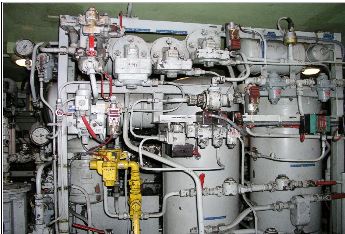
Foto 2: Pohled na vzduchový panel HDV řady 163. Uzavírací kohout č. 976/5 (rubos/litina) se nachází v levé střední části snímku v uzavřené poloze
