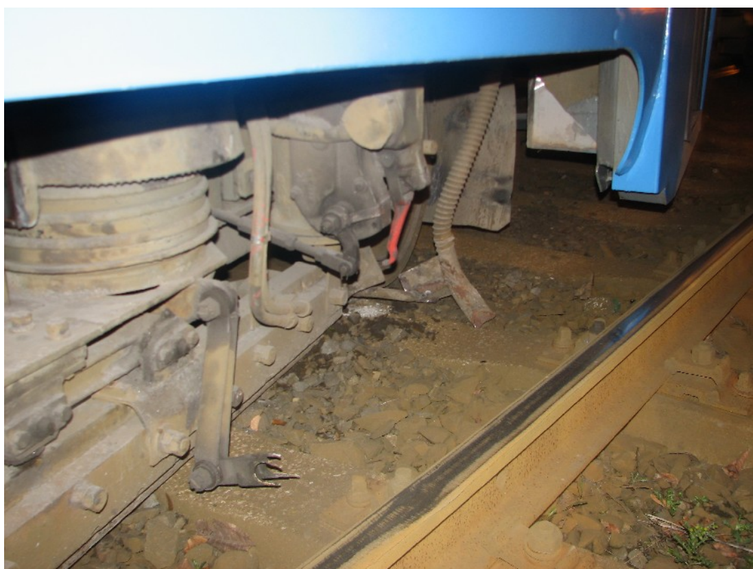
Foto č. 4: Detail vykolejeného podvozku
