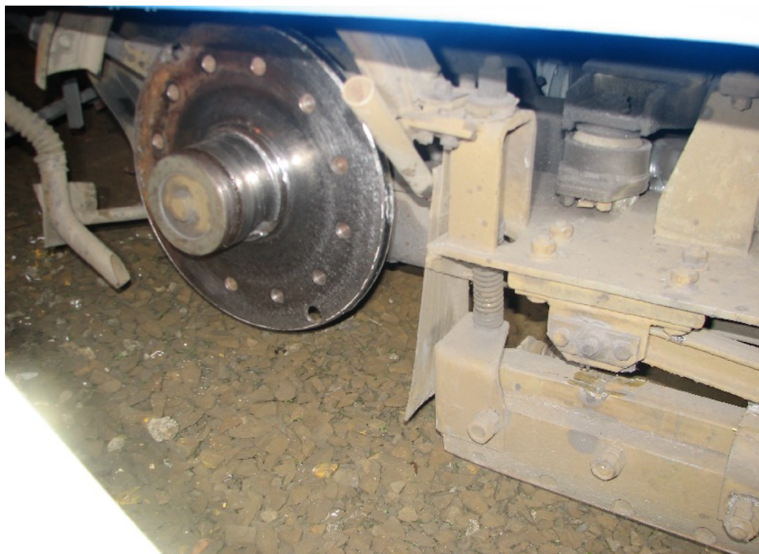
Foto č. 3: Náprava MTV po upadnutí kola a vykolejení
