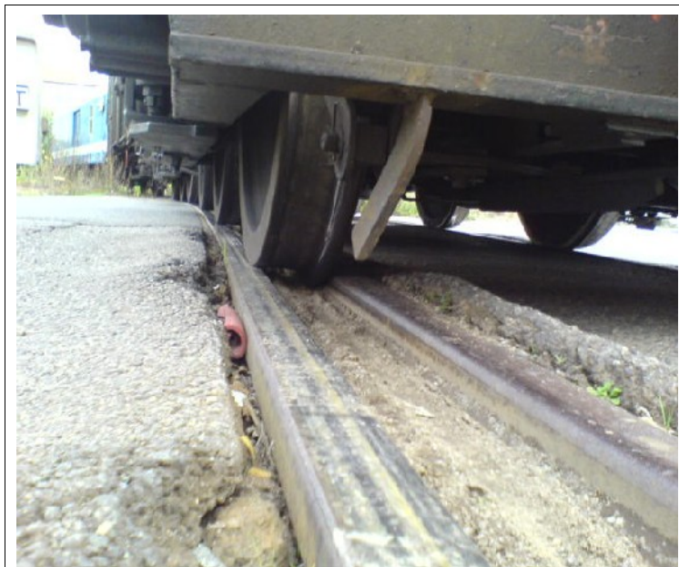
Foto 3: Poloha pravého kola první nápravy nehodového vlaku v km 0,596 v místě změny vzepětí
