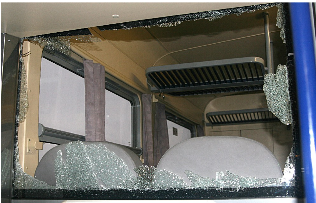
Příloha 6: Roztříštěná skleněná výplň přepážky
