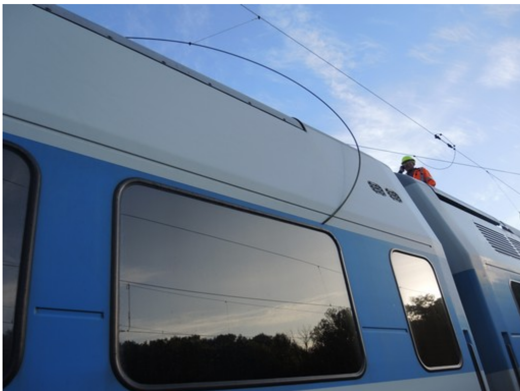
Obr. č. 1: Pohled na poškozené TV
