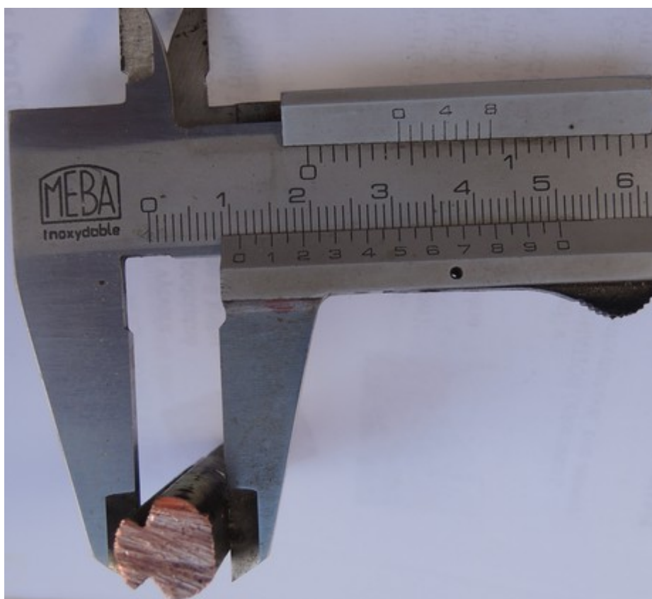
Obr. č. 3: Výška profilového trolejového drátu 4 cm před místem poškození
