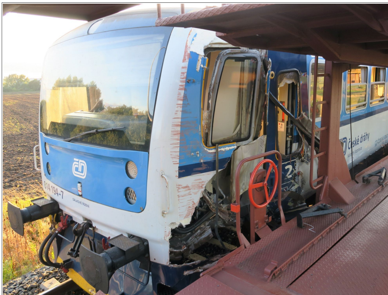
Obr. č. 8: Pohled na poškozenou kabinu strojvedoucího a levou část vozové skříně vlaku Os 6051 v konečném postavení po vzniku MU
