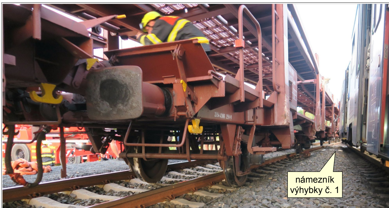
Obr. č. 3: Pohled na oběma nápravami vykolejený článek „A“ TDV 23 54 4366 259-0, s nárazníky zaklesnutými do před ním řazeného TDV 23 54 4366 136-0, v konečném postavení po vzniku MU
