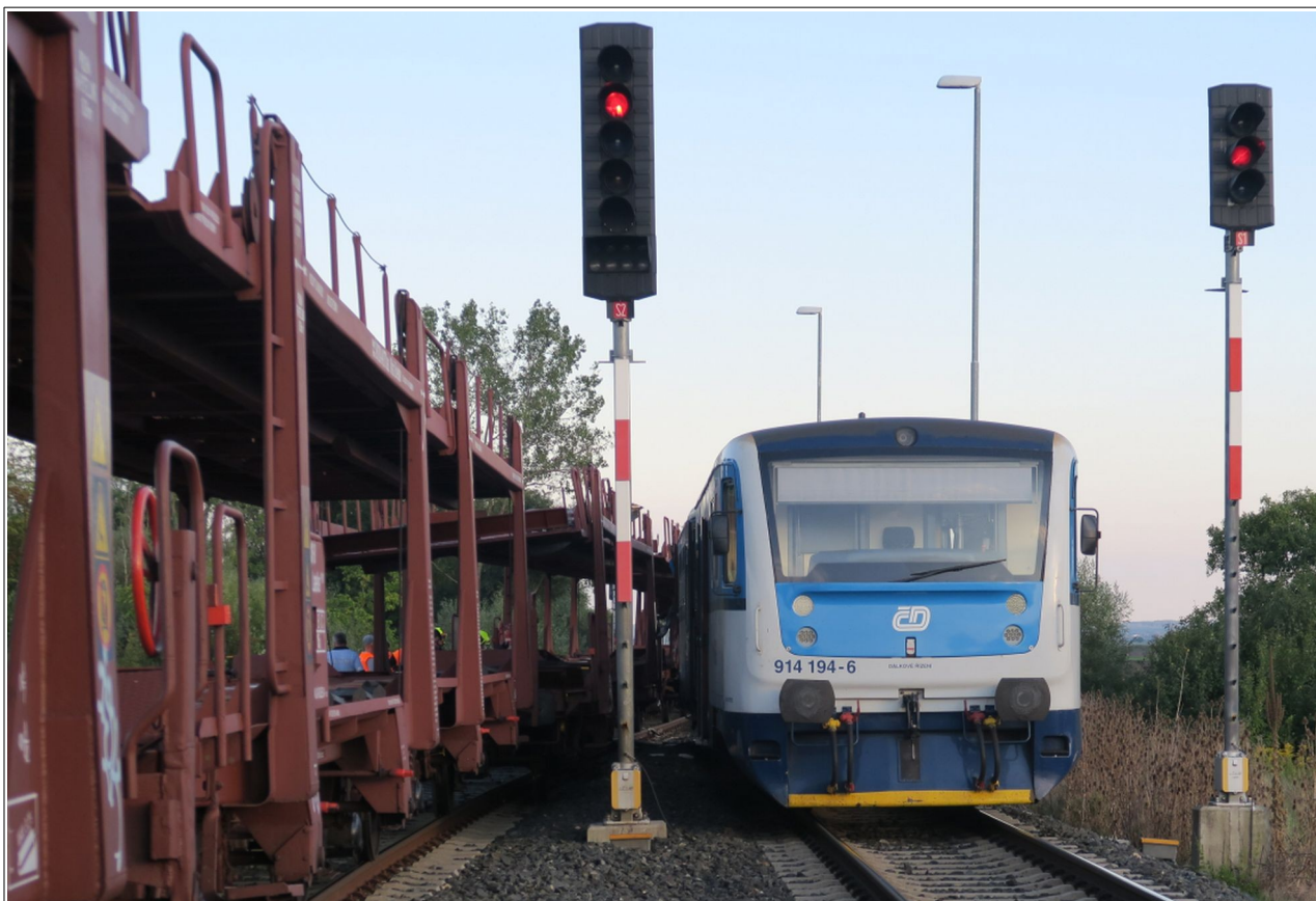
Obr. č. 2: Pohled na odjezdová návěstidla S1 a S2 výhybny Bezděčín po vzniku MU
