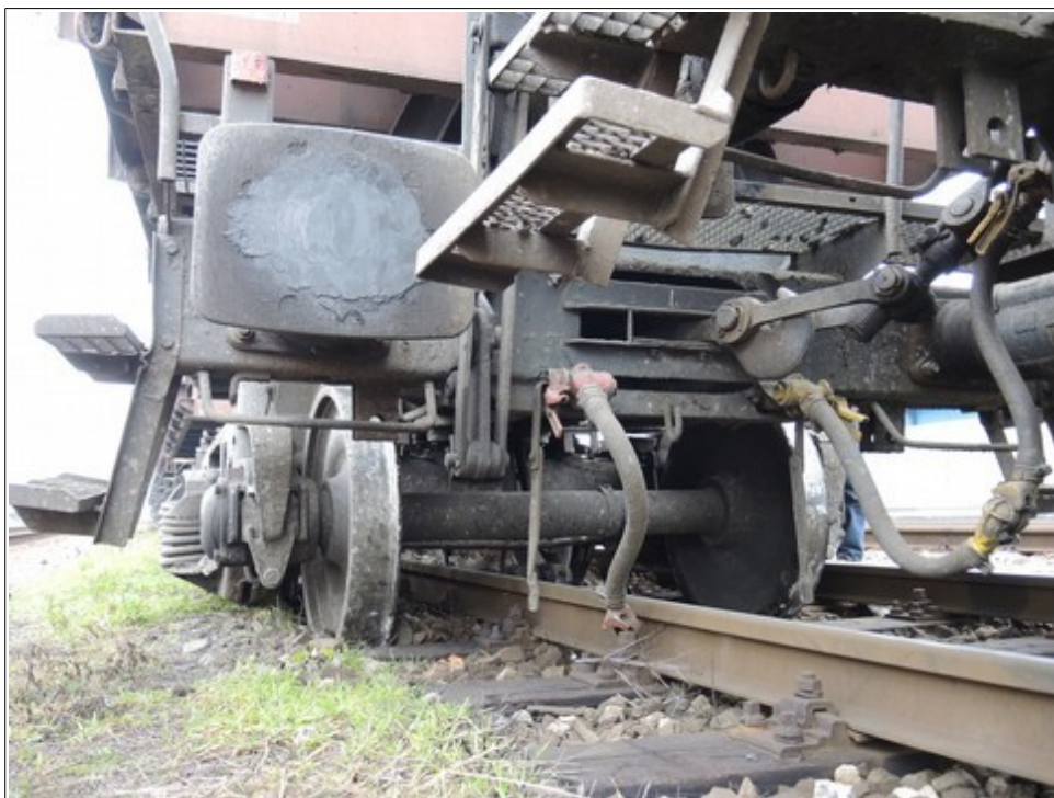
Obr. č. 5: Vykolejený podvozek „a“ 8. TDV za HDV vlaku Pn 49792 v konečném postavení po vzniku MU.
