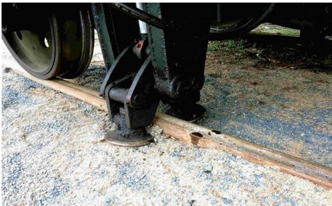
Obr. č. 10: Detail hydraulického upínadla SVP-74
