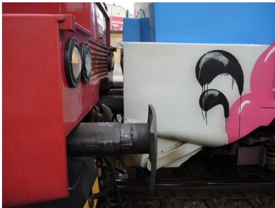
Obr. č. 13: Pohled na poškození souprav při srážce
