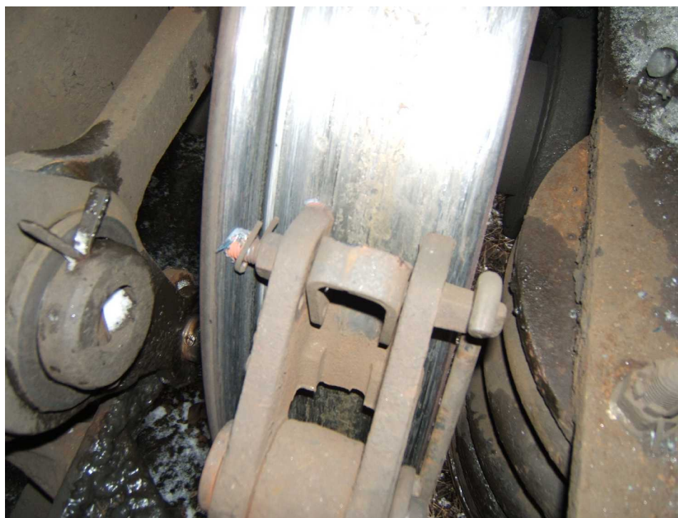
Foto 5: Brzdová botka s nezajištěnou speciální překlopnou pojistkou TDV řady AB, č. 50 54 39-40 243-7
