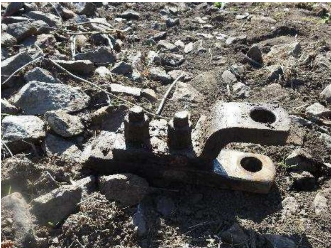
Obr. č. 8: Pohled na utržený závěs traktoru
