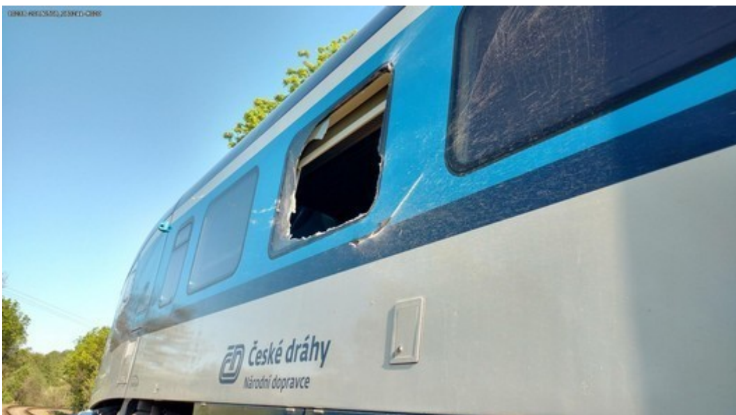
Obr. č. 10: Pohled na rozbité boční okno vlaku Os 5340
