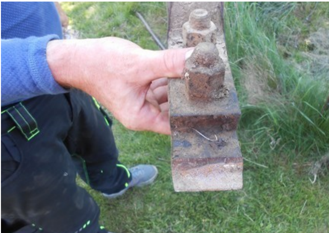
Obr. č. 9: Pohled na lom utrženého závěs traktoru
