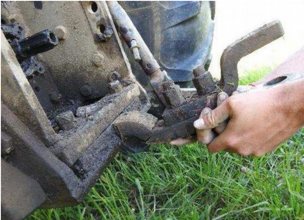
Obr. č. 7: Celkový pohled na zadní část traktoru a na ulomený závěs
