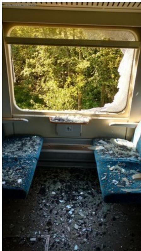
Obr. č. 6: Pohled na rozbité boční okno v interieru vlaku Os 5340
