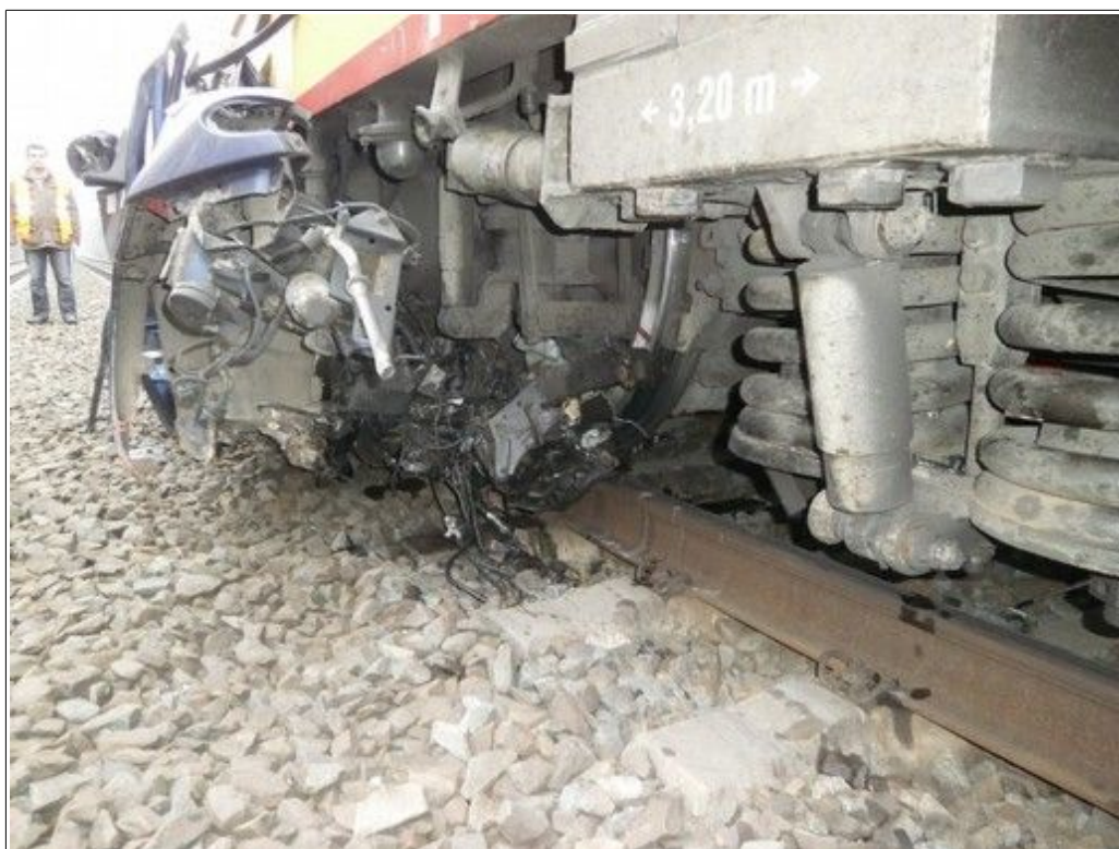
Obr. č. 6: Trosky zaklíněného OA pod čelo HDV 151.014-8
