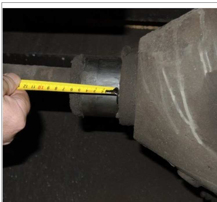
Obr. č. 4: Nedostatečný zdvih pístu brzdového válce Zdroj: DI
