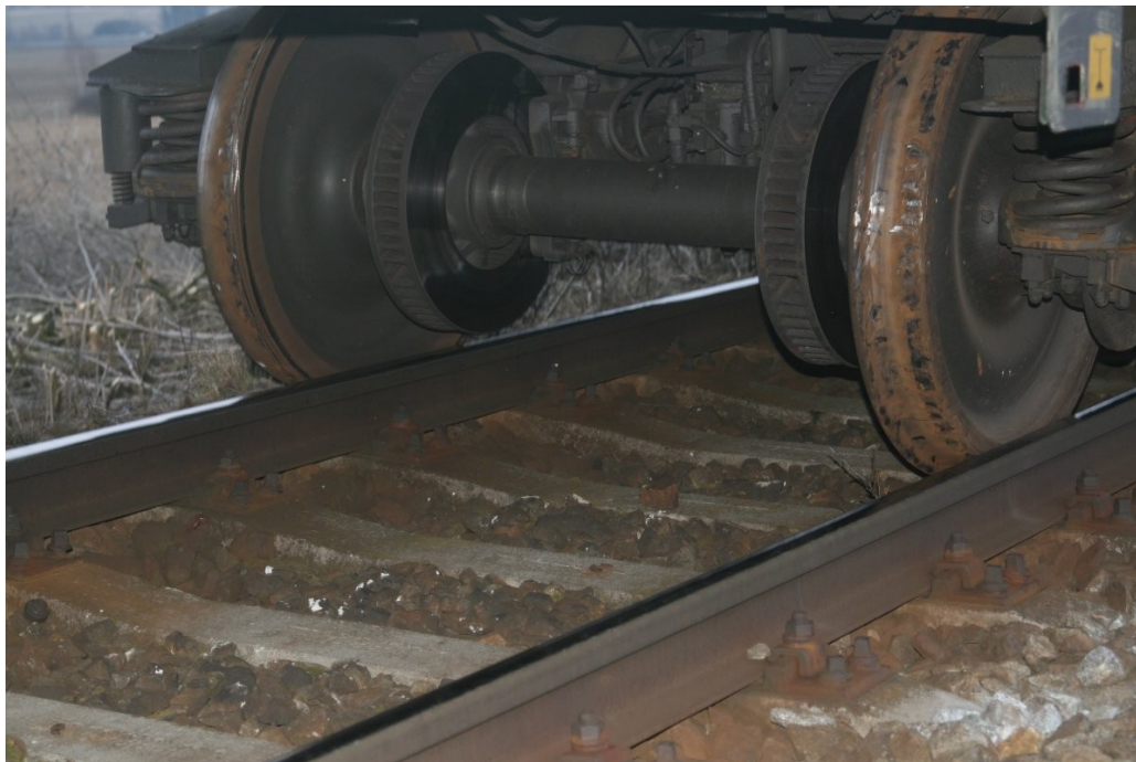
Obr. č. 3: Vykolejené dvojkolí
